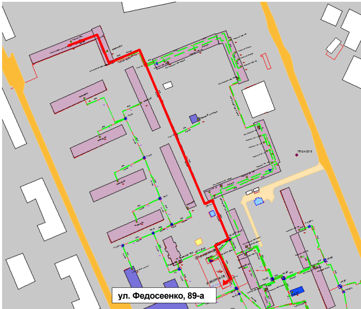
Рисунок 1.97 – Результат гидравлического расчета - расчетный путь теплоносителя от котельной ул. Федосеенко, 89-а до ПТ-Федос,98а мастер
