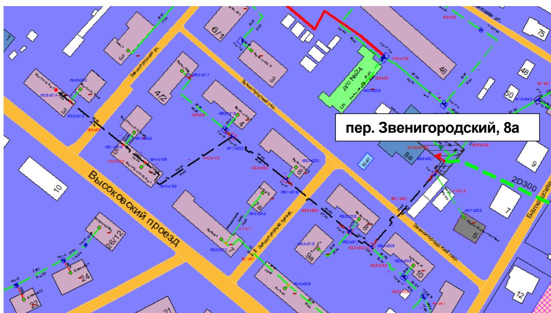
Рисунок 1.49 – Результат гидравлического расчета - расчетный путь теплоносителя от котельной пер. Звенигородский, 8а до ПТ-Выс.пр,3 в1
